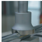
Küçük Silindirik Destek Halkasıyla Silindirik Sertliğini Ölçme
